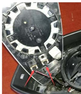
2.4、拔下两根除雾线，取下镜片
