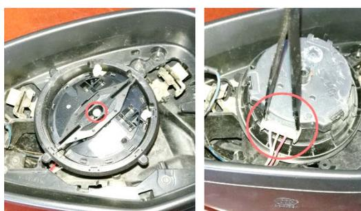
2.5、取下 1 螺钉与三个卡扣，拆下镜片驱动器，用镊子撬出 3Pin 插头并把 Pin 退出（注意拍照以记住线序）
