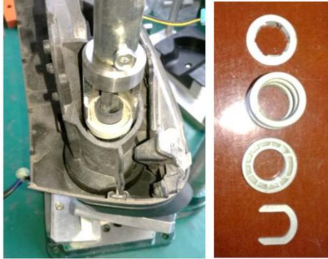
2.11、用专用治具将弹簧垫圈下压，压
