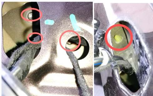
2.2、取下孔内 3 颗螺钉，拔下门内腔的线卡，再拔下线扣，拆下后视镜。
