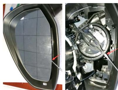
2.3、下压镜片，用一字批插入镜片驱动器的限位耳和镜片之间，旋转一字批，松开卡扣
