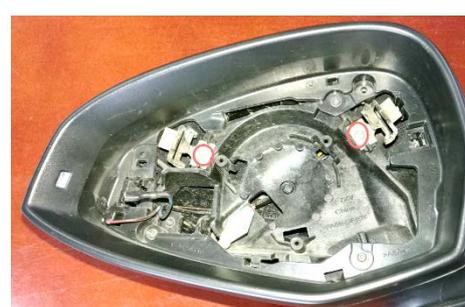
2.6、取下镜片导向弹片(2 颗螺钉)
