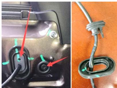
2.1、取下 2 个螺钉孔橡胶盖，将大胶盖拆开，方便穿过孔
